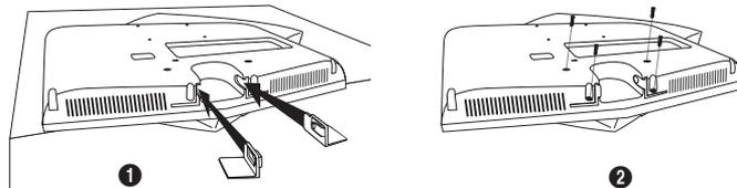
1. Pour installer le téléviseur sur un mur sans utiliser le support, placer les couvercles décoratifs dans les orifices, tel qu'indiqué sur l'image ①.
